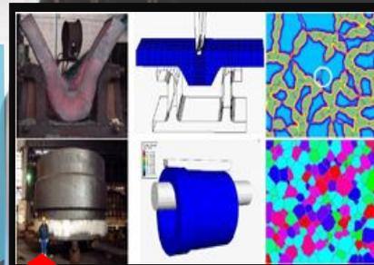
在面向实际工程的大规模模拟计算领域，中科院网络中心超算中心使用深腾高性能服务器完成了大型铸锻件的模拟计算软件的并行化，将计算时间从3个月缩短为**8小时**（128核计算结果），该软件可应用于三峡水轮机组、核电压力容器、大型船用曲轴、大型轧钢支承辊等大型铸锻件的工业生产中。
